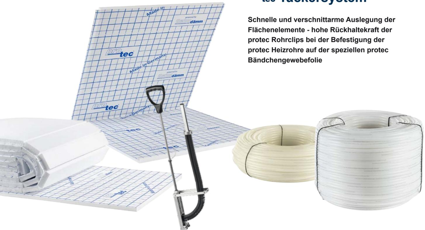
Die pro-tec Rollbahnen und Faltplatten mit aufkaschierter Bändchengewebefolie sind die Grundelemente des Tackersystems. Sie dienen zur Wärmedämmung sowie als Rohrträgerelemente. Die auf der Folie aufgedruckte Rasterung ermöglicht das Ausrichten der Heizrohre auf der Fläche, die dann mittels der pro-tec Rohrclips sicher in der pro-tec Bändchengewebefolie arretiert werden.
